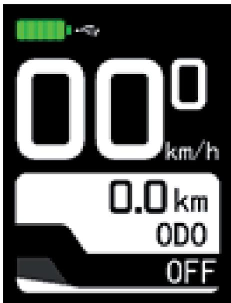
L'afficheur possède un port USB qui permet de brancher un appareil.
