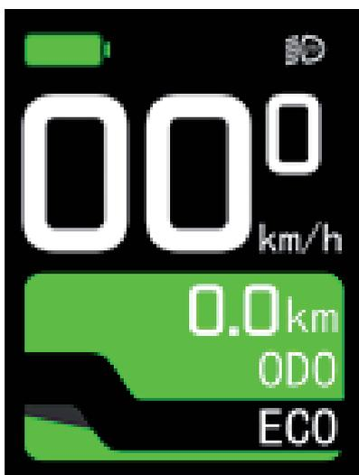
Votre afficheur est lui aussi rétro éclairé. La luminosité de l'écran est réglable en appuyant sur les boutons “+” et “-” simultanément. Dans le menu, sélectionner Paramètres puis Luminosité et sélectionner le % qui vous convient.
